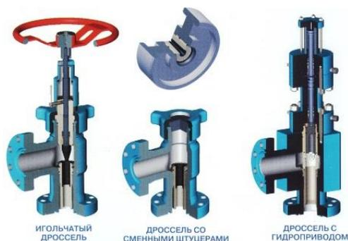
Дроссель - устройство для ограничения подачи жидкости или регулирования потока рабочего материала. Регулирование в данном случае осуществляется за счет изменения сечения проходного отверстия, при котором создается гидравлическое сопротивление. Другими словами, дросселирование осуществляется за счет уменьшения или увеличения отверстия, через которое проходит среда. При уменьшении отверстия теряется удельная энергия среды, скорость ее течения уменьшается, а давление на регулируемом участке падает.
