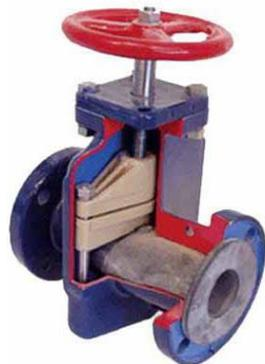
В шланговой задвижке поток транспортируемой среды производится через эластичный шланг, который пережимается штоком для прекращения подачи среды. Все металлические детали такой задвижки полностью изолированы от среды таким шлангом (патрубком).
